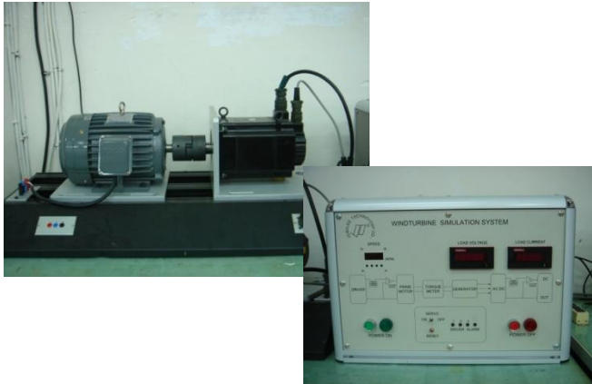
感應發電機組平台
