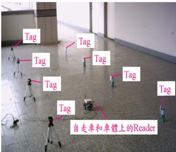
圖 7 自走車以直線移動定位實驗圖
