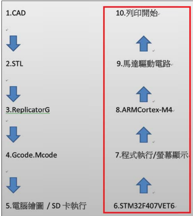
圖(一) 大行程 3D 列印流程(紅色框為本計畫完成部分)
