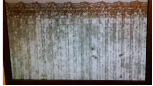
圖十:使用超音波震洗機顯影之示意圖。途中上方可以看出即使降低電壓震洗依然會將形狀給震散。
