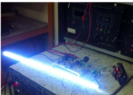
圖 3-5 Zigbee 遠端遙控測試 (100%)
