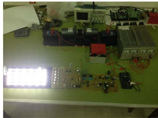
圖 10 LED 功率 32.1 W 的系統整合實測
